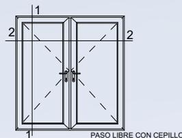
ACRISTALAMIENTO DESDE 4 mm HASTA 36 mm DE ESPESOR. DISEÑO DE 4 CÁMARAS DE AISLACIÓN EN MARCO.
