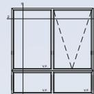
ACRISTALAMIENTO DESDE 4mm HASTA 36mm DE ESPESOR. DISEÑO DE 4 CÁMARAS DE AISLACIÓN EN MARCO.
